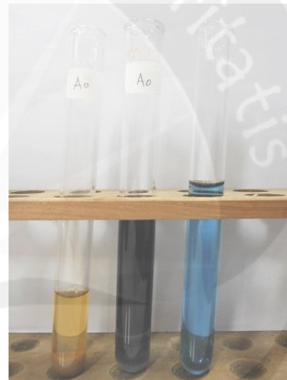
Gambar 36. Uji Gula Reduksi (kiri-kanan: sampel medium, hasil akhir reaksi, pengenceran)
