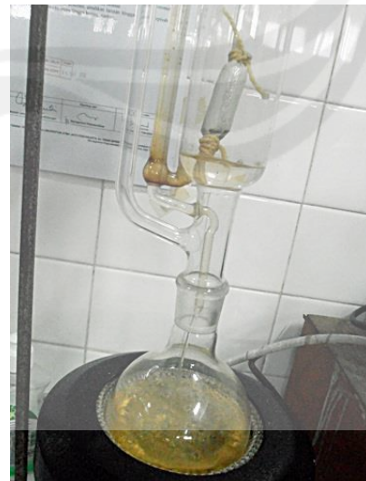
Gambar 44. Proses Ekstraksi Soxhlet
