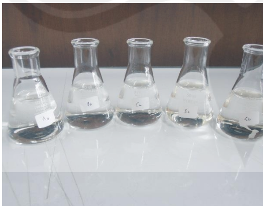
Gambar 37. Sampel Sebelum Ditambah Reagen Nessler
