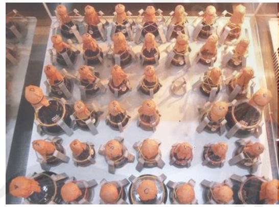
Gambar 30. Inkubasi Kultur dalam Shaker Incubator
