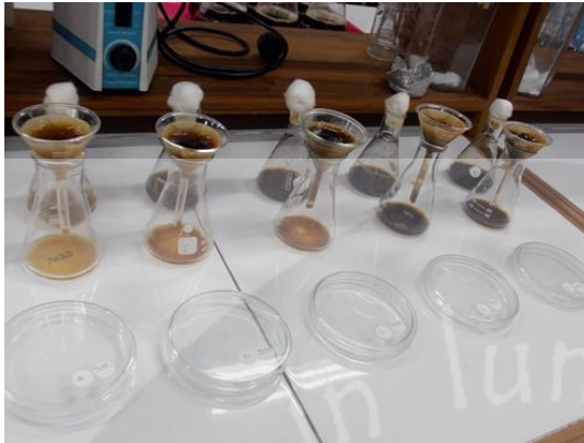
Gambar 33. Penyaringan Biomassa P. pinophilum dari Medium
