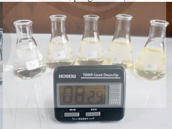
Gambar 38. Perubahan Warna Sampel Setelah Ditambah Reagen Nessler pada Waktu 8 Menit 29 Detik
