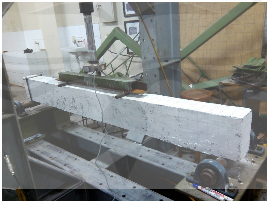
Gambar Balok Hasil Pengujian Lentur
