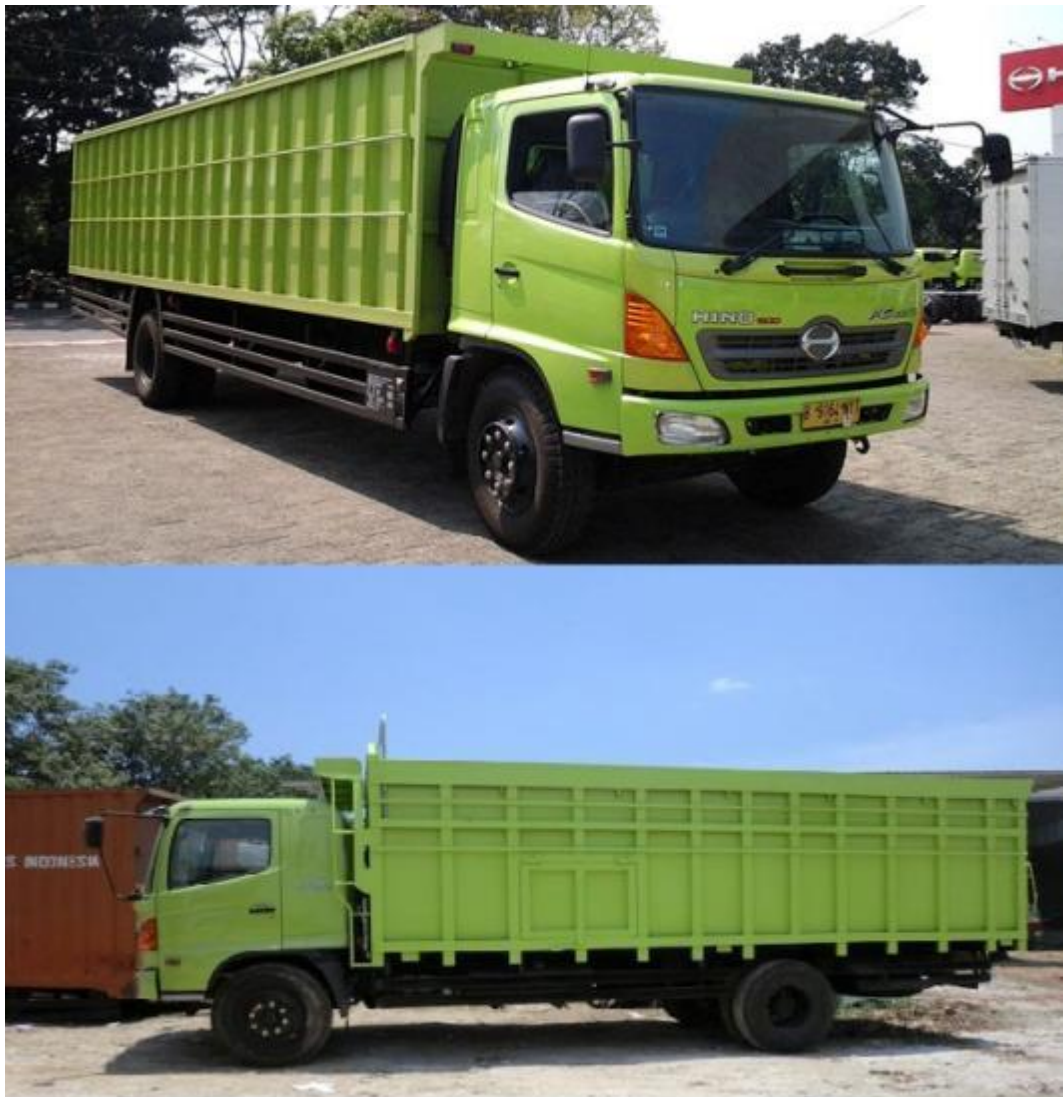
Foto 9. Model armada truk baru jenis Hino tipe 235 PS (FG 235 JP) yang sudah dilengkapi bak.
