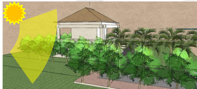
Gambar 5.15 Penataan Vegetasi dan Pengadaan Sun Shading Pada Bangunan
