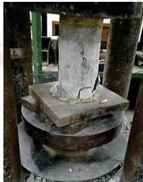
Gambar L4.8. Foto Silinder Beton Setelah Diuji
