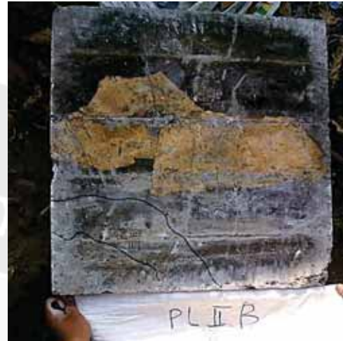
Gambar L4.18. Foto Retak pada Bawah Pelat Setelah Diuji
