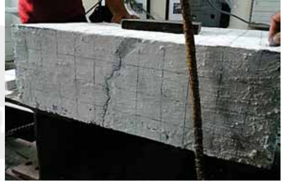
Gambar L4.14. Foto Retak pada Pelat PL2A Setelah Diuji
