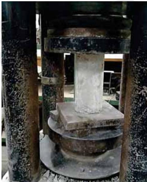
Gambar L4.7. Foto Pengujian Silinder Beton
