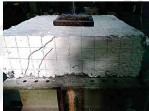
Gambar L4.12. Foto Retak pada Pelat PL1B Setelah Diuji
