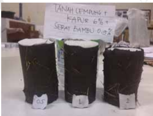
Gambar : Skema Sampel Uji Hasil Uji Triaksial UU
