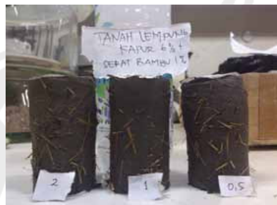
Gambar : Skema Sampel Uji Hasil Uji Triaksial UU
