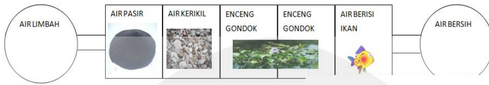
Gambar 6.26 Instalasi Penyaringan Air Limbah
