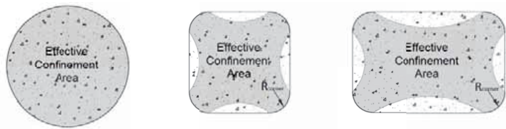
Gambar 2.1 Area kekangan efektif pada penampang bulat, persegi, dan persegi panjang
