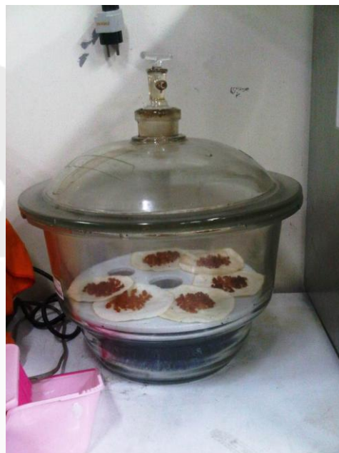
Gambar 24. Pengukuran Pertambahan Berat Kristal Alga setelah Pengovenan Dilanjutkan Pendinginan Menggunakan Eksikator.
