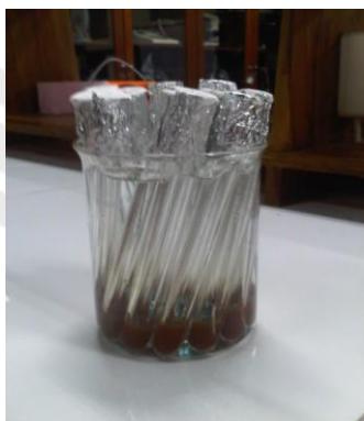
Gambar 25. Pengukuran Kadar gula Reduksi Kristal Alga Dipanaskan Menggunakan Kompor.
