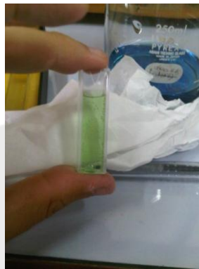
Gambar 27. Pengukuran Kadar Gula Reduksi kristal Alga Dihitung Absorbansi Menggunakan Spektrofotometri UV-Vis.
