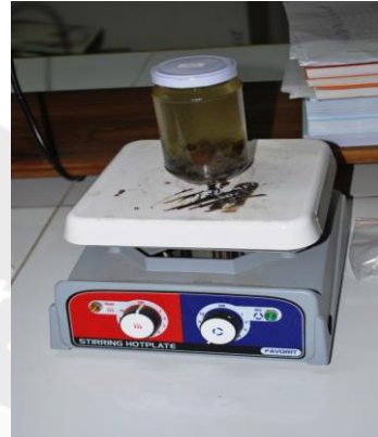
Gambar 21. Proses Homogenasi Kristal alga dengan medium menggunakan magnetic stirrer.
