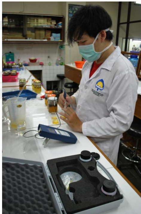
Gambar 22. Uji Derajat Keasaman (pH) Kristal Alga Menggunakan pH meter.
