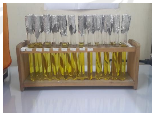
Gambar 30. Larutan Bikromat Asam dalam Metode Conway Diencerkan Hingga 10 ml dan Diukur Menggunakan Spektrofotometri UV-Vis.
