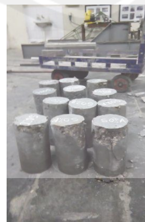
Silinder setelah diuji
