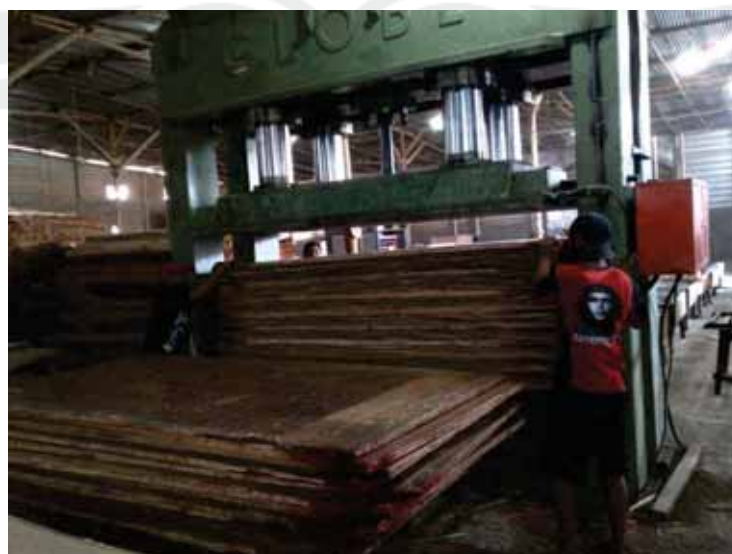
Gambar 6. Operator memindahkan plywood ke mesin coldpress
