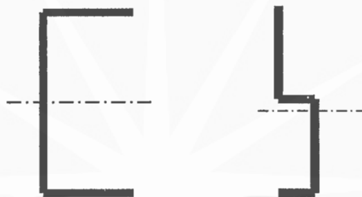
Gambar 2.2. dinding geser yang terdiri dari gabungan beberapa dinding
