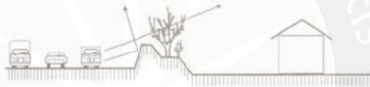
Gbr VI.24. Konsep Sound Barrier Sumber Gbr: Egan, 1976 dalam Mediastika, 2005
