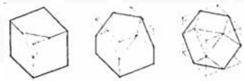
Gambar 4. 5. Transformasi Substraktif Sumber: Ching, 2007
