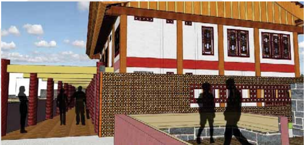
Gambar 6.11 Dinding roster sebagai sekat pembatas
