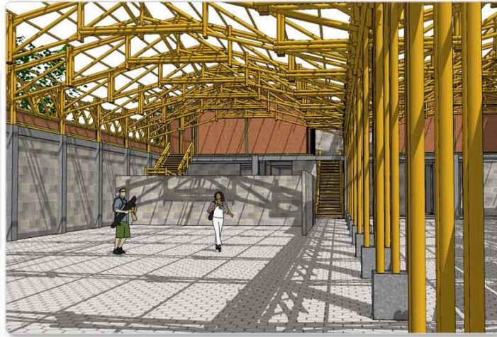
Gambar 5.8. Konstruksi Beton yang dipadukan dengan Konstruksi Bambu Sumber ; Analisis Penulis,
