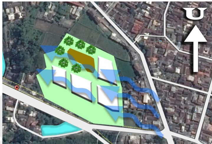
Gambar 5.9. penempatan massa pada bangunan atas tanggapan pada aliran angin Sumber. Analisis penulis
