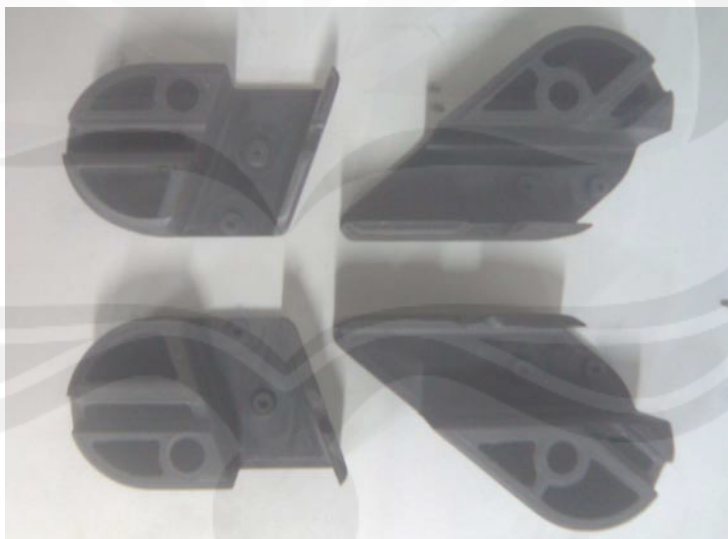
Gambar 6.2. Prototype bagian back hasil permesinan CNC
