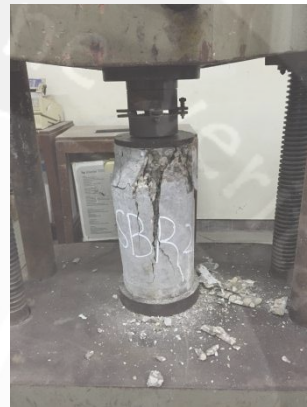
Pengujian Kuat Desak Menggunakan Silinder Beton ringan
