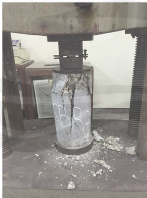
Benda Uji Silinder Beton Ringan Setelah Pengujian
