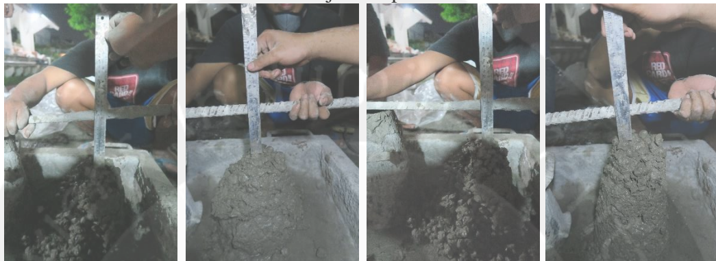
Slump Test Beton Ringan Tanpa Serat
