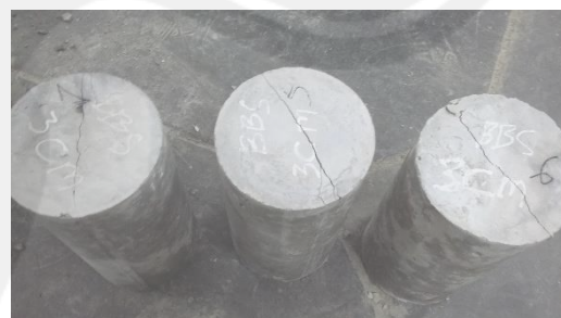
Benda uji silinder Aspek Rasio 46,15 setelah pengujian
