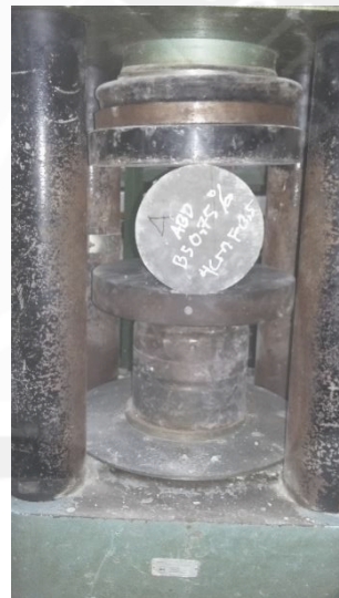
Pengujian Kuat Tarik Belah Menggunakan Silinder Beton
