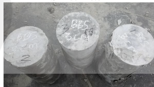
Benda uji silinder Aspek Rasio 46,15 setelah pengujian
