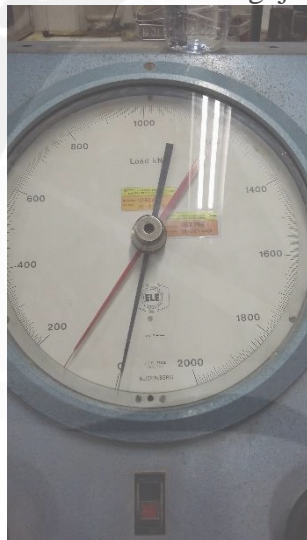
Pembacaan Pembebanan pada mesin desak ELE
