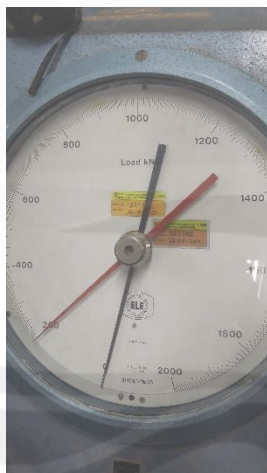
Pembacaan Pembebanan pada mesin desak ELE
