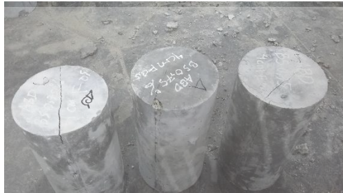
Benda uji silinder Aspek Rasio 61,54 setelah pengujian
