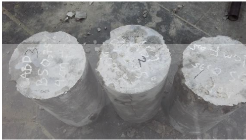
Benda uji silinder Aspek Rasio 61,54 setelah pengujian
