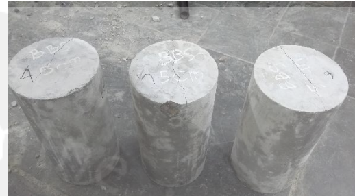
Benda uji silinder Aspek Rasio 76,92 setelah pengujian
