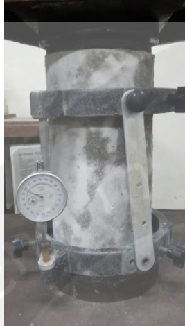
Pengujian dengan kompressometer
