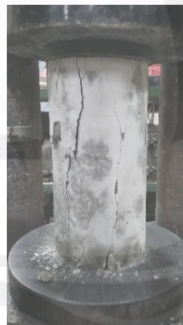
Pengujian Kuat Desak Menggunakan Silinder Beton
