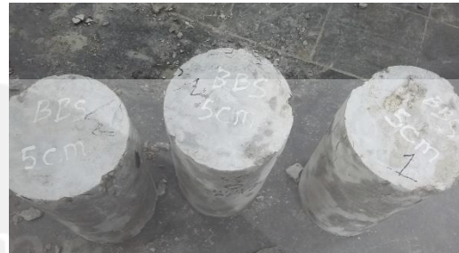
Benda uji silinder Aspek Rasio 76,92 setelah pengujian
