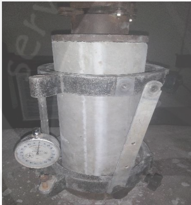
Pengujian modulus elastisitas
