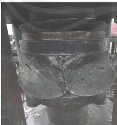
Pengujian tarik belah beton
