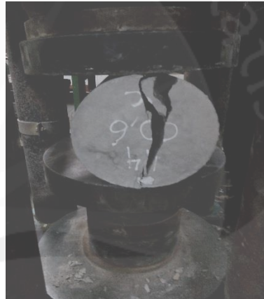
Pengujian tarik belah beton
