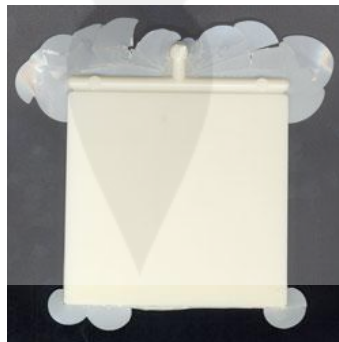
Gambar. 2.13. Produk Flashing (Defect pada produk plastik, Tresno, 2010)
