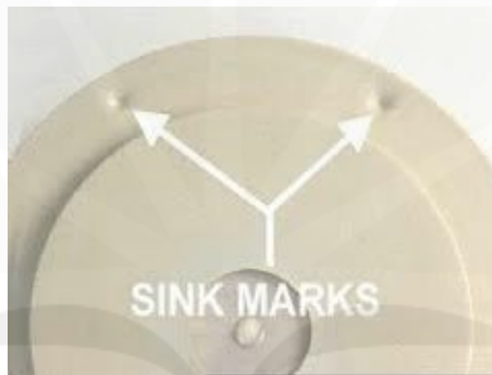
Gambar. 2.14. Produk Sink-mark (Defect pada produk plastik, Tresno, 2010)
