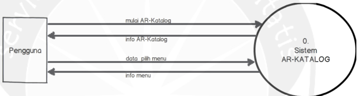
Gambar 2 Topologi dari DFD AR-Katalog Level 0
