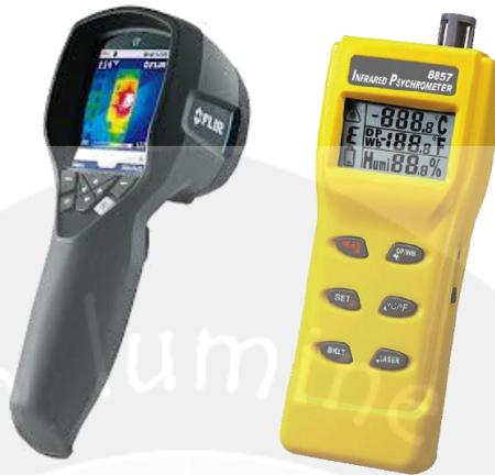
**Gambar 3.1.** Kamera IR FLIR i5 (kiri) dan *infrared psychrometer*.
