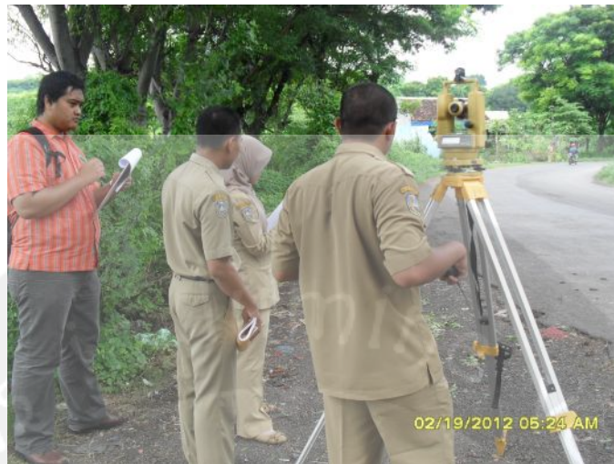
Pengukuran Beda Tinggi
