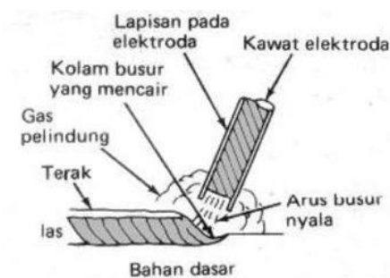
Gambar 2.5 Las Busur Dengan Elektroda Terbungkus (Wiryosumarto dan Okumura, 1981)
