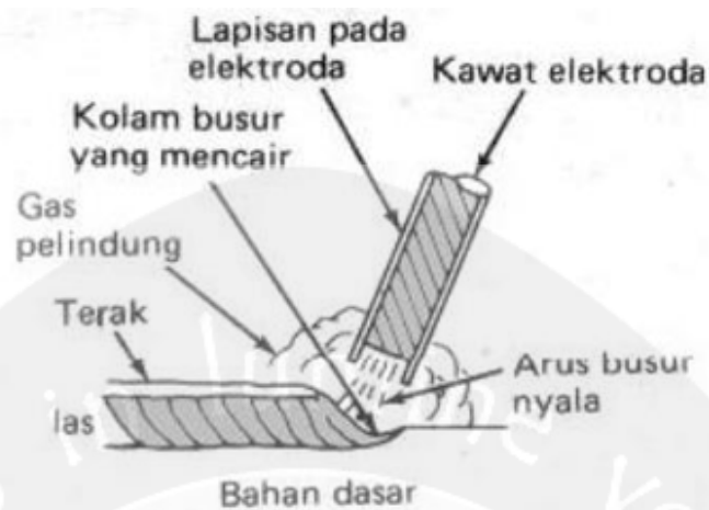
Gambar 2.5 Las Busur Dengan Elektroda Terbungkus (Wirjosumarto dan Okumura, 1981)
