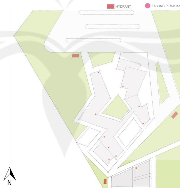
Gambar 6.13 Skema Peletakkan Alat Pemadam Kebakaran
