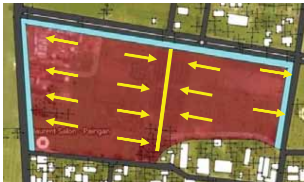
Gambar 6.10 Drainase Ditambahkan pada Bagian Tengah
