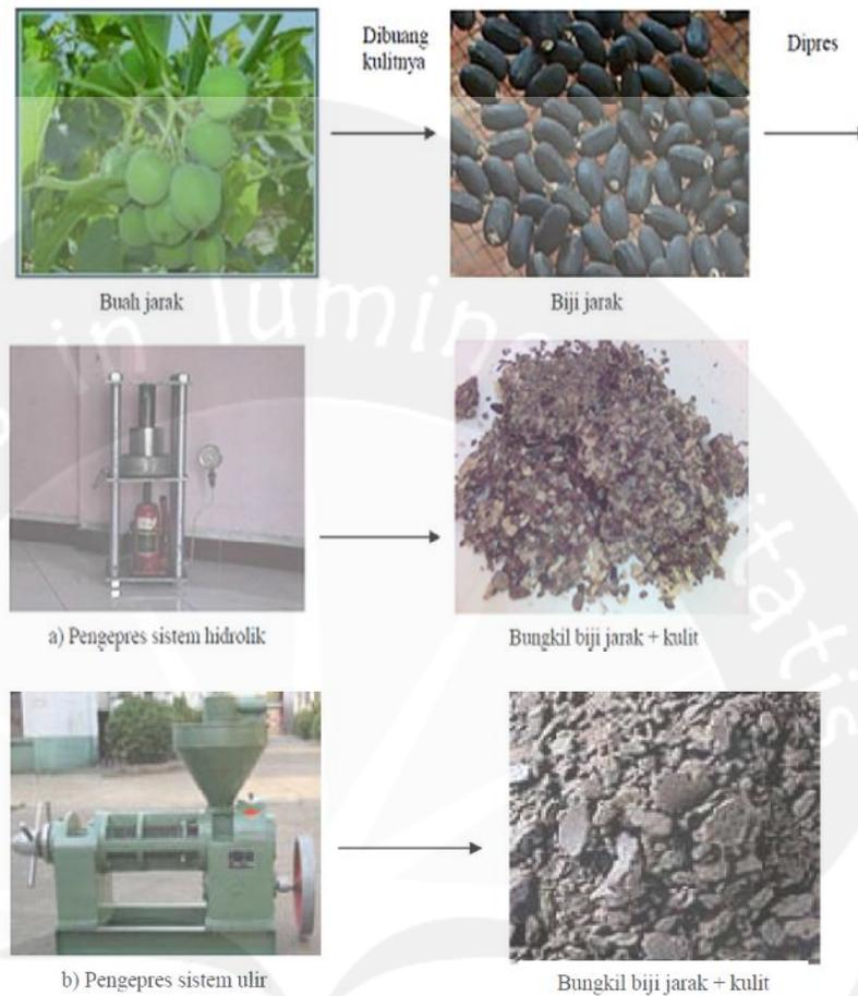
Gambar 2. Skema pengepresan biji jarak memakai a) pengepres sistem hidrolis (*hydraulic press*) dan b) pengepres sistem ulir (*screw press*)
