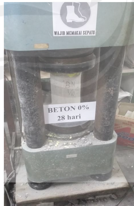
Pengujian kuat tekan beton dengan mesin desak ELE
