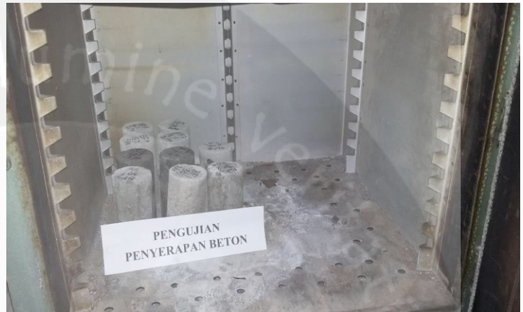
Pengujian penyerapan beton
