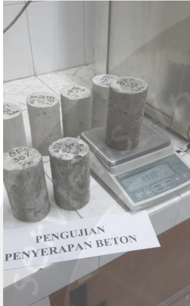
Pengujian penyerapan beton
