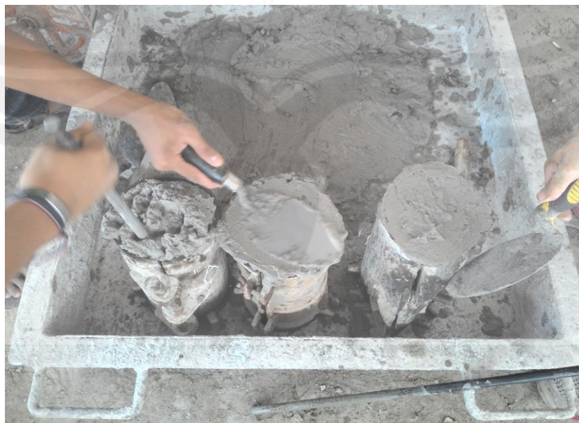
Proses pencetakan beton
