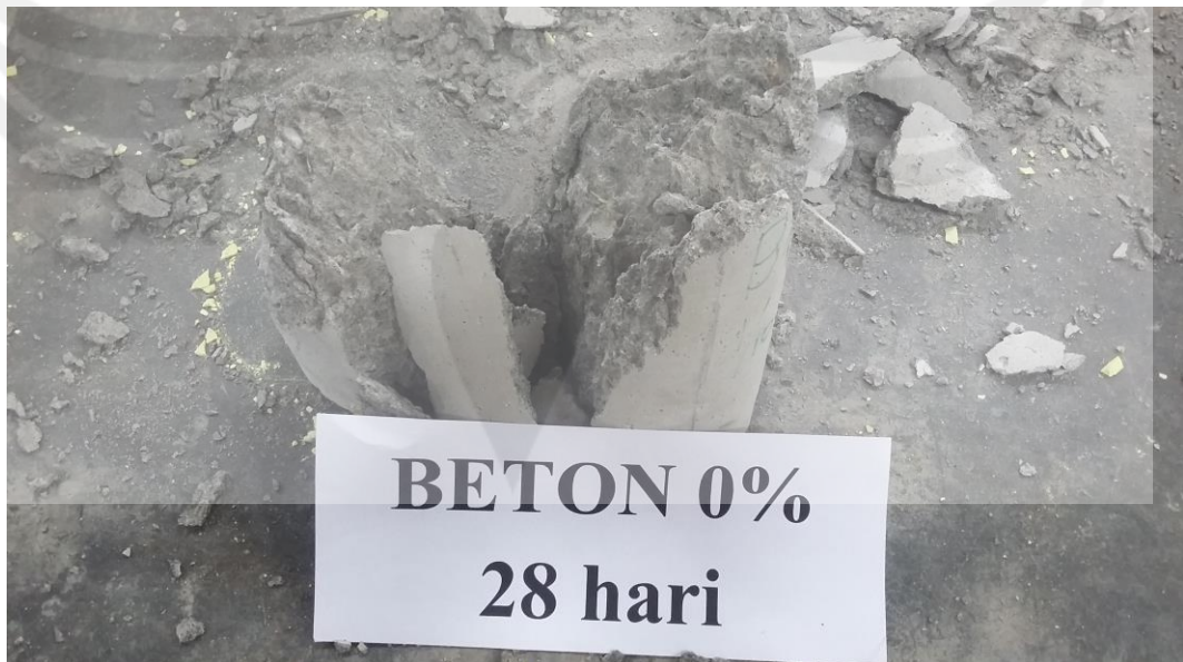
Hasil pengujian kuat tekan beton
