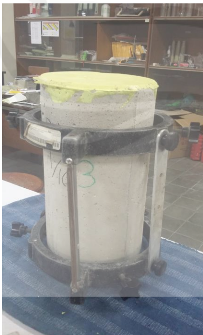
Pengujian modulus elastisitas beton
