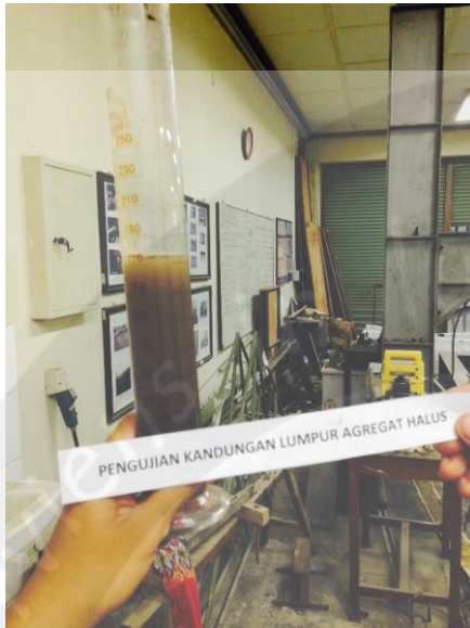
Pengujian kandungan lumpur pasir
