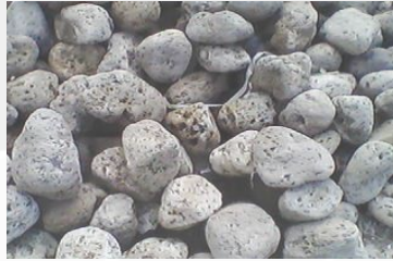
Gambar 4.1. Agregat Kasar (Batu Apung)
