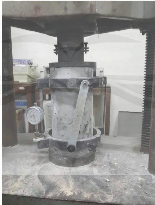
Gambar 5.10 Pengujian Modulus Elastisitas
