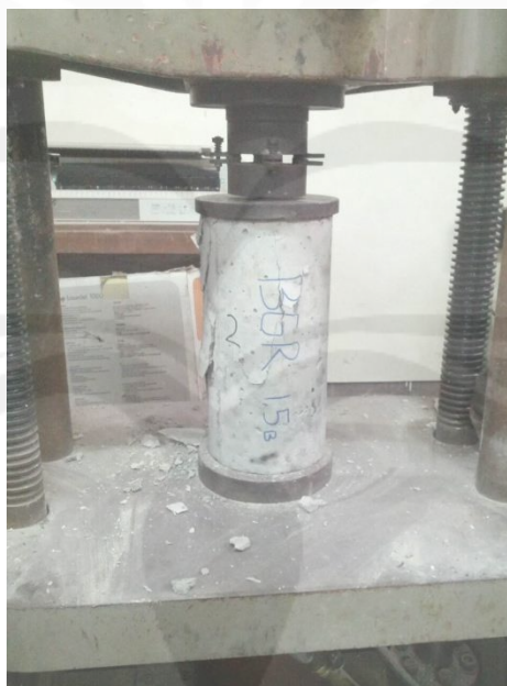
Benda Uji Setelah di Uji Tekan 7 Hari
