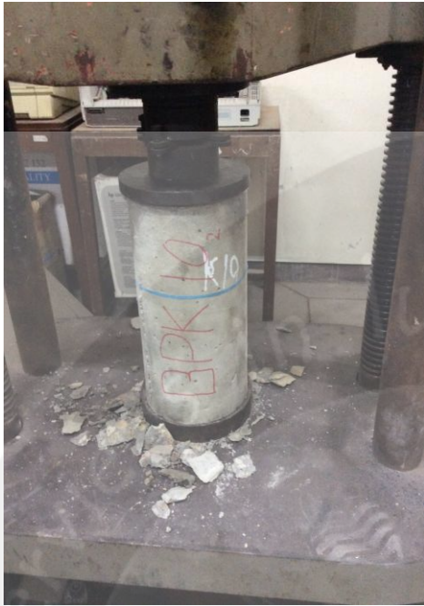
Pengujian beton umur 14 hari
