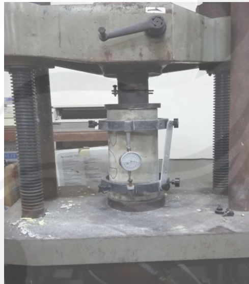
Pengujian beton umur 28 hari
