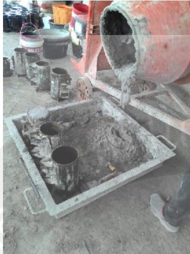
Penuangan Adukan Beton Foam
