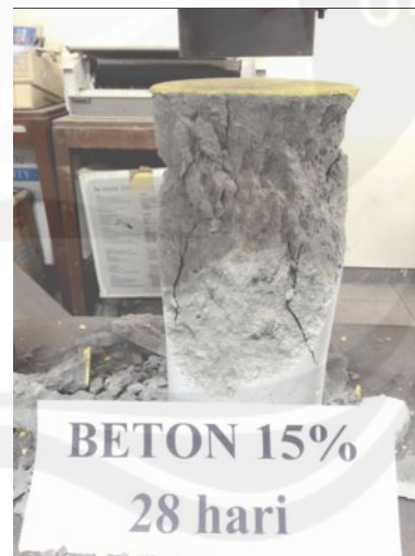
Retakan Beton SF15%
