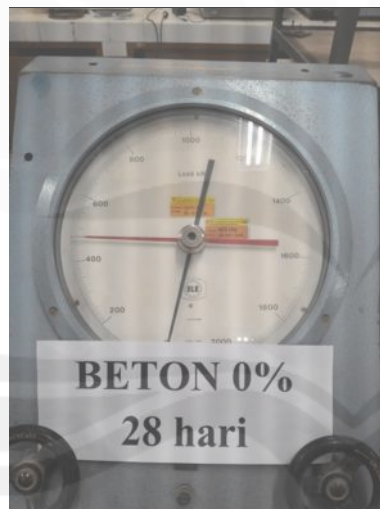
Pengujian Beton Normal
