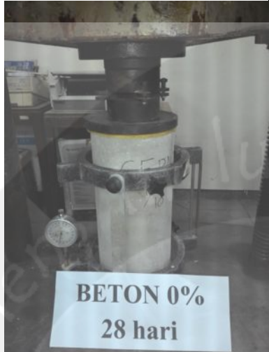
Pengujian Beton Normal
