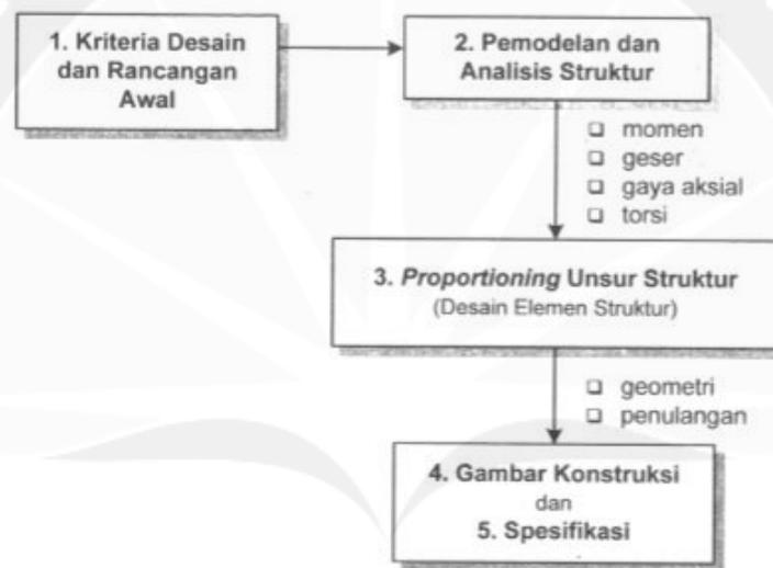
**Gambar 2.1 Bagan Alur Langkah-langkah Perancangan**
