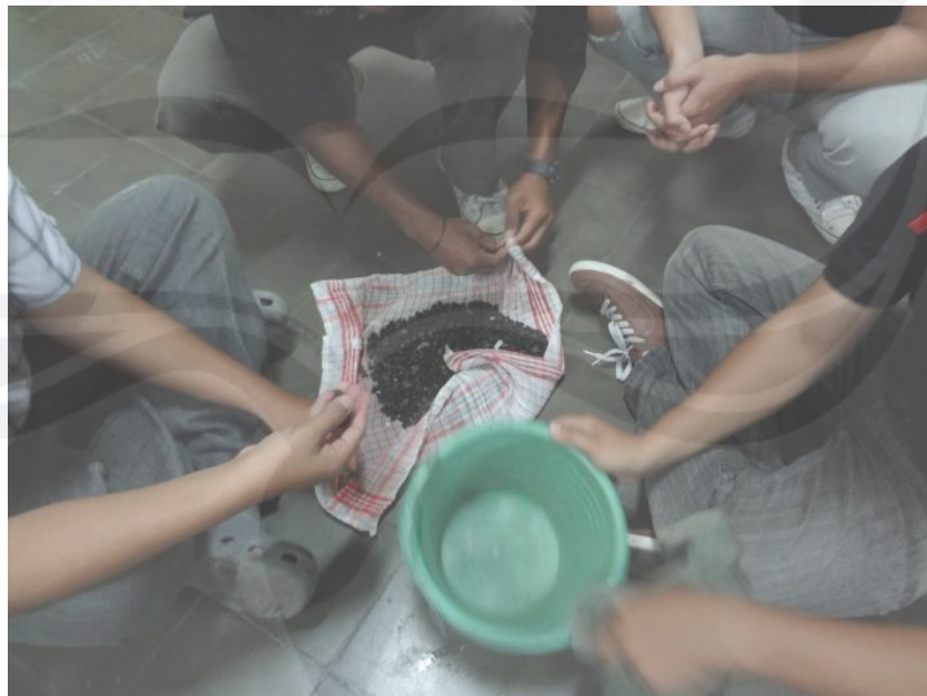
Gambar 6. Pengeringan Permukaan Kerikil
