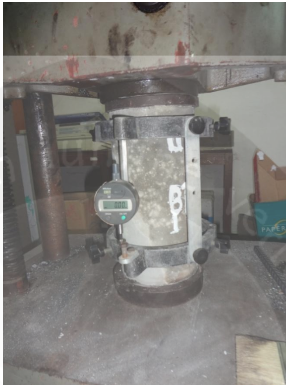
Gambar 13. Pengujian Modulus Elastik Silinder Beton
