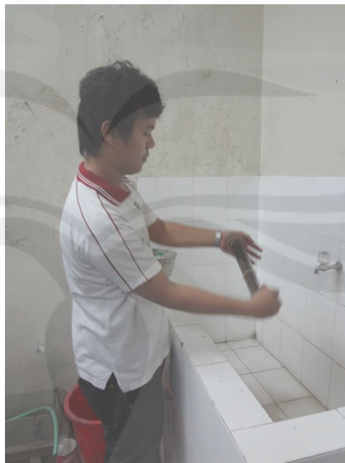
Gambar 2. Pengujian Pemeriksaan Kandungan Lumpur dalam Pasir
