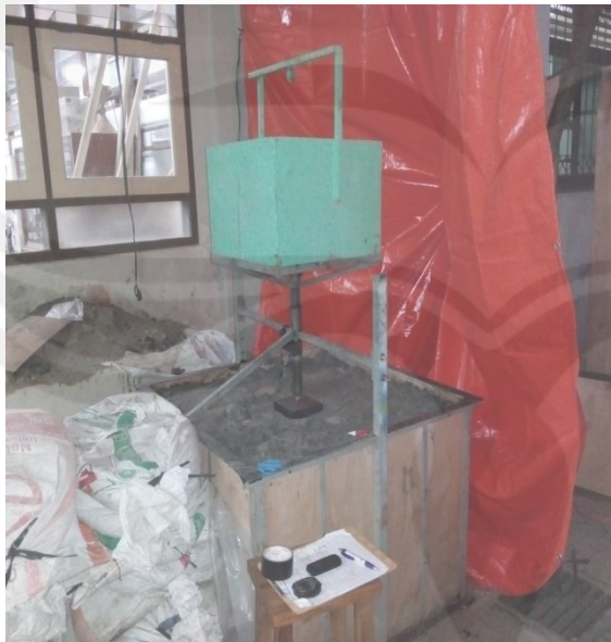
(Sumber : Foto ) Proses Set Alat Pembebanan (BK'') Lapis 1 10 cm & Lapis 2 20 cm
