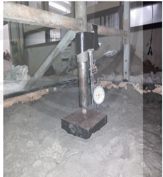
(Sumber : Foto ) Proses Set Alat Pembebanan (TL)
