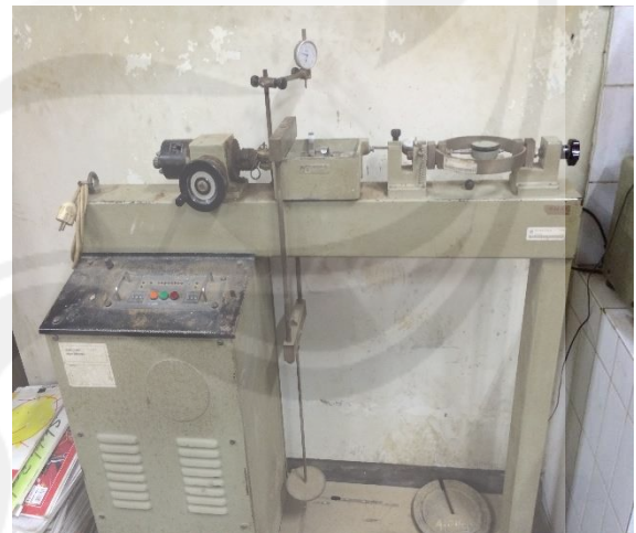
( Sumber : Foto ) Pengujian Berat Volume dan Geser Langsung
