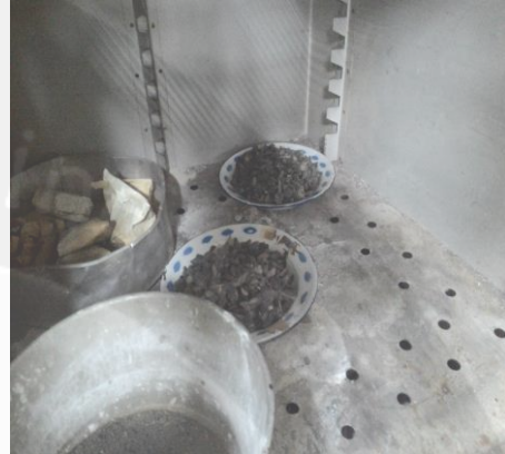
Pengujian Berat Jenis Agregat Kasar
