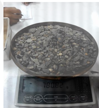
Pengujian Gradasi Agregat Kasar
