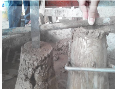
Pengujian Nilai Slump
