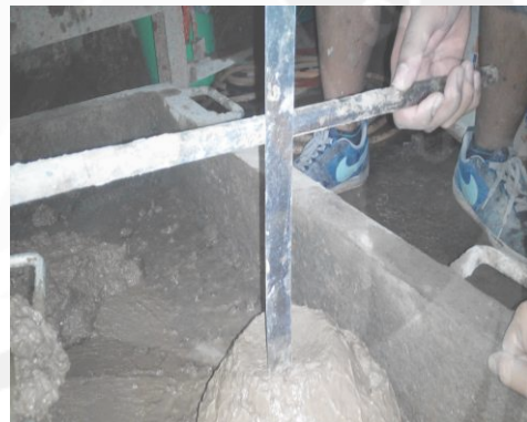
Pengujian Nilai Slump
