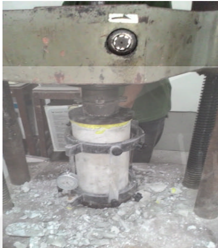
Silinder Beton Sebelum Diuji
