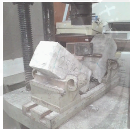
Balok Beton Setelah Diuji
