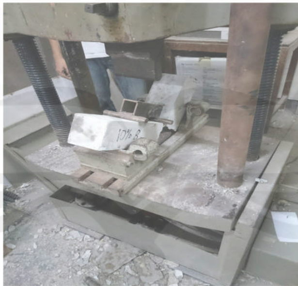
Gambar 9. Patahan Hasil Pengujian Kuat Lentur
