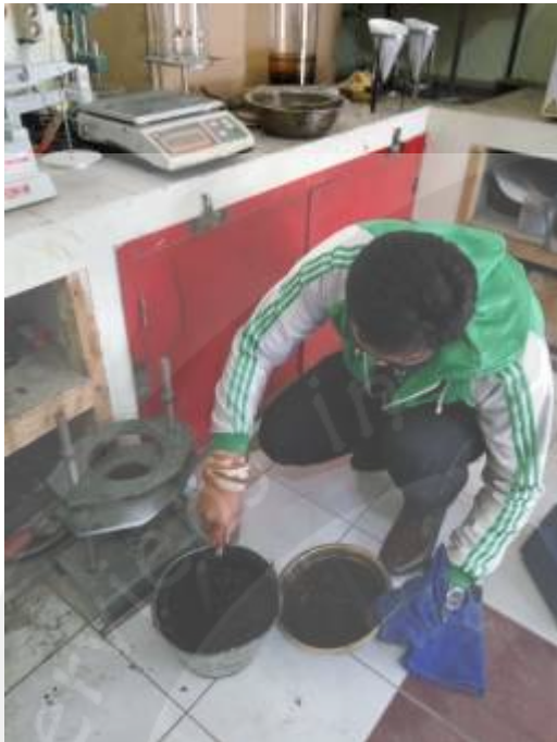
Pengambilan Campuran Agregat
