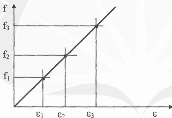
Gambar 2.8a Diagram tegangan-regangan untuk bahan elastis linier
