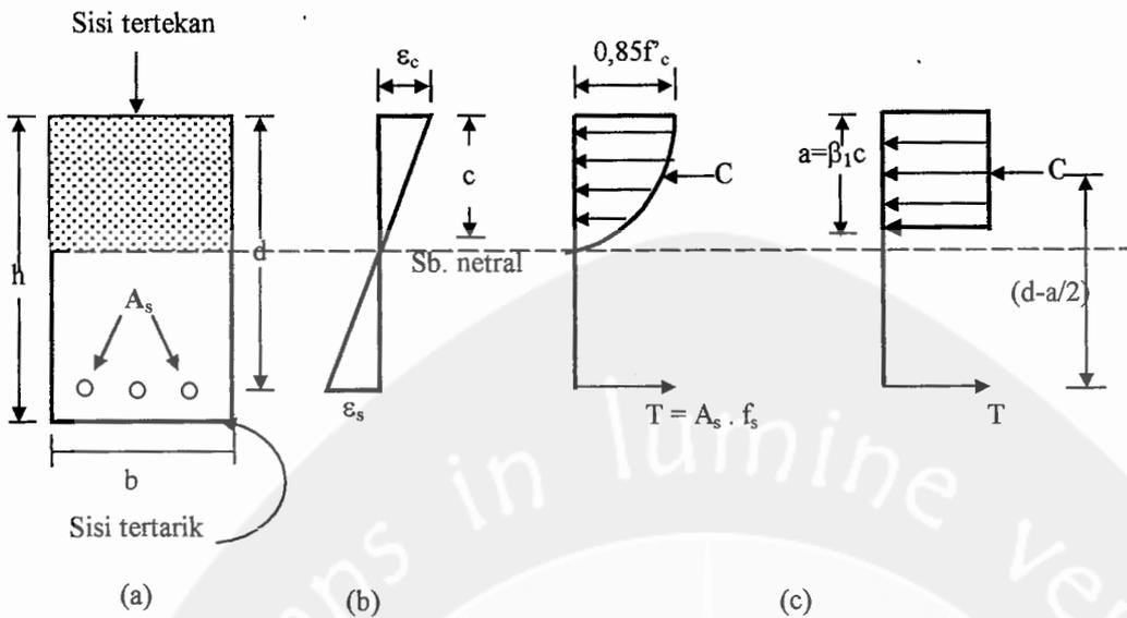
Gambar 2.9 Distribusi tegangan dan regangan pada penampang balok. (a) penampang melintang balok (b) regangan (c) blok tegangan ekuivalen yang diasumsikan
