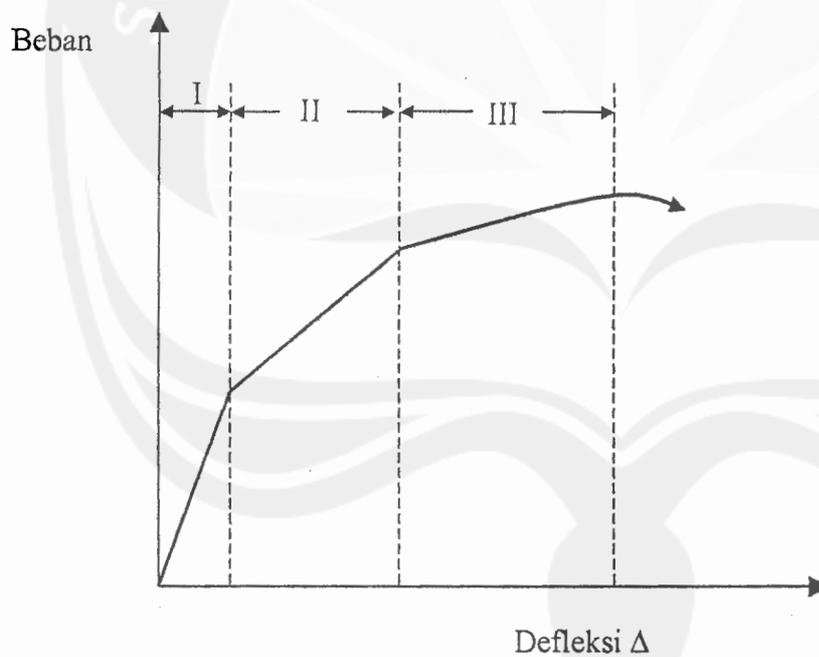
**Gambar 2.11.** Hubungan beban-lendutan pada balok. Daerah I, taraf praretak; daerah II, taraf pascaretak; daerah III, taraf *post-serviceability* (tulangan baja meleleh)
