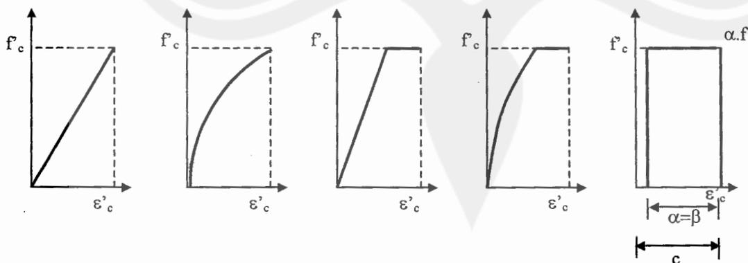
Gambar 2.7 Diagram  $\sigma$ - $\varepsilon$  beton yang diskematisasikan
