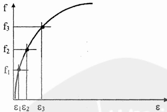
Gambar 2.8c Hubungan linier antara tegangan-regangan pada nilai tegangan yang rendah; hubungan ini tidak lagi linier pada tegangan yang lebih tinggi
