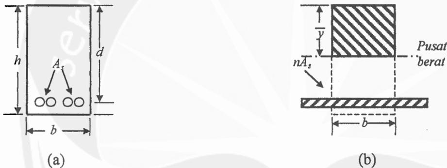
Gambar 2.12. Transformasi penampang melintang. (a) penampang lapangan; (b) penampang transformasi.
