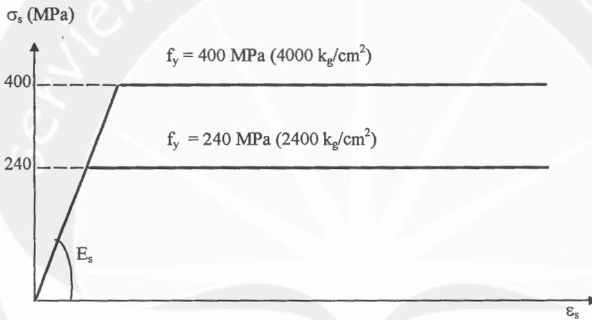
Gambar 2.6 Diagram  $\sigma$ - $\varepsilon$  baja yang diskematisasikan
