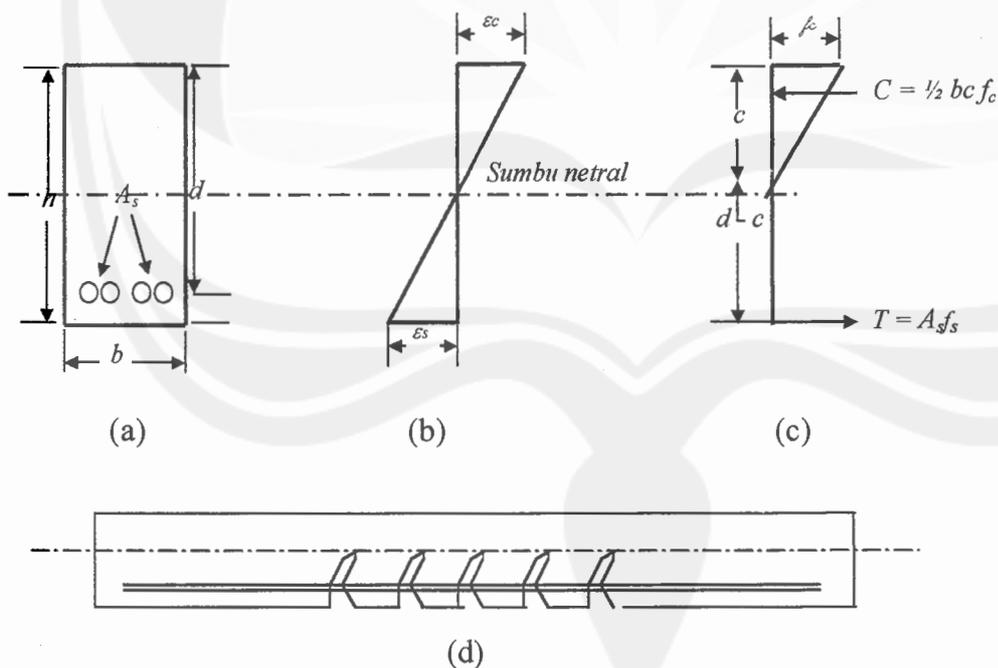
Gambar 2.13. Distribusi tegangan dan regangan pada penampang beton bertulang yang retak dan transformasinya. (a) penampang melintang; (b) regangan; (c) tegangan elastis dan gaya; (d) beton retak sebelum terjadinya keruntuhan lentur.
